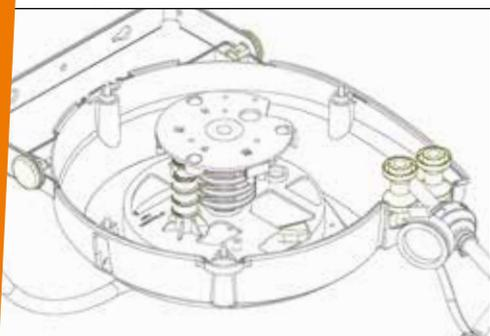
Todos os enroladores de cabo - com uma secção até 3Gx2,5mm<sup>2</sup> - são fornecidos com **interruptores de proteção térmica**, que são acionados em caso de sobrecarga do circuito elétrico.
